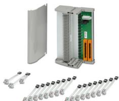
Termination Carrier per il collegamento ridondante di 16 isolatori galvanici MACX Analog Ex i NAMUR a schede di ingresso analogiche del controllore Yokogawa ProSafe-RS, mediante due connettori KS50, 50 poli. Adatto per la scheda Yokogawa SDV144.
