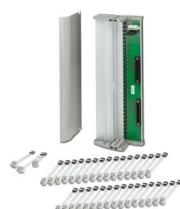
Termination Carrier per il collegamento ridondante di 32 blocchi di controllo valvola MACX Analog Ex i a schede di uscita digitali del controllore Yokogawa Centum VP, mediante due connettori KS50, 50 poli. Indicato per schede Yokogawa ADV 551 e ADV 561.
