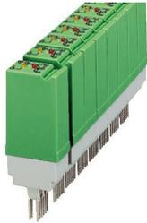
Relè a stato solido di potenza a innesto, con LED e protezione nei circuiti di ingresso e uscita, ingresso: 12 V DC, uscita: anticortocircuito, 10-30 V DC/max. 2 A, innestabile su morsetti base
