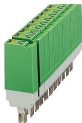
Relè a stato solido di potenza a innesto, con LED e protezione nei circuiti di ingresso e uscita, ingresso: 24 V DC, uscita: 12-60 V DC/max. 1 A, innestabile su morsetti base
