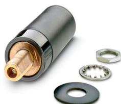
Antenna omnidirezionale, 868 MHz / 900 MHz, guadagno: 2 dBi, polarizzazione: lineare, angolo di apertura: h/v 360°/50°, grado di protezione: IP66, connessione: N (femmina), per montaggio in armadio di comando (montaggio a parete opzionale)
