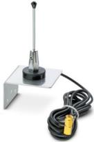
Antenna omnidirezionale, 900 MHz, guadagno: 2 dBi, polarizzazione: lineare, grado di protezione: IP65, connessione: RSMA (maschio), incl. cavo di connessione da 1,8 m e supporto angolare per il montaggio a parete
