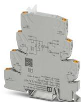
PLC-INTERFACE per funzioni di output, composta da morsetto base PLC-BPT.../ACT con connessione Push-in e relè a stato solido in miniatura integrato, per il montaggio su guida di montaggio NS 35/7,5, 1 contatto aperto a riposo, ingresso: 24 V DC, uscita: 24-253 V AC/2,4 A
