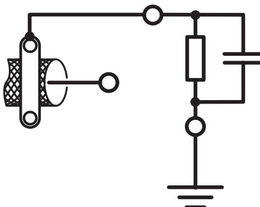
Connessione schermata mediante elemento RC alla PE
