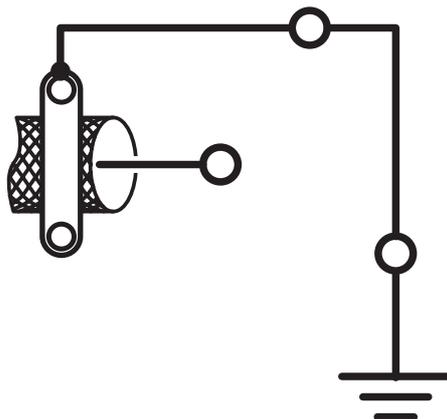
Connessione schermata direttamente alla PE
