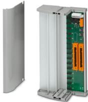
Termination Carrier per il collegamento ridondante di 16 moduli PSR-FSP alle schede di uscita digitali del controllore Yokogawa ProSafe-RS, mediante due connettori KS50, 50 poli. Soluzione per applicazioni Emergency Shut Down (ESD). Adatto per la scheda Yokogawa SDV541.
