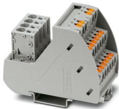
Modulo VARIOFACE con due barre equipotenziali (P1, P2) per la ripartizione del potenziale, per l'installazione su guide di montaggio NS 35. Larghezza modulo: 41,9 mm
