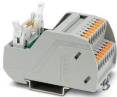
Modulo VARIOFACE con connessioni Push-in e connettore maschio per cavo piatto per l'installazione su guide di montaggio NS 35, con connettori maschio e staffe di bloccaggio corte e lunghe per connettori femmina, n. poli: 16
