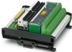
Modulo relè a 16 canali per moduli di uscita Honeywell C300 TDOB01 e TDOB11. Il modulo viene gestito sul lato controllore mediante D-SUB da 37 poli. Sul lato campo è disponibile una connessione a vite (siglatura: 1...48). Larghezza modulo: 142 mm
