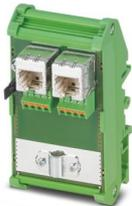
Modulo Cable Sharing, due connettori femmina RJ45 con equipaggiamento Ethernet (uscita cavo in avanti) su 8 morsetti a molla, CAT5e, 10/100 MBit/s, montaggio su guida di supporto, IP20, a scelta schermatura verso la guida di supporto mediante Jumper
