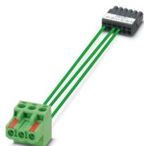
Set di cavi per la trasmissione di segnale e alimentazione di tensione sul Termination Carrier per moduli di accoppiamento della serie PSR-ETP. Collegamento dei punti di connessione A1 e A2 (trasmissione del segnale) e V+ (alimentazione di tensione) su scheda segnale. Adatto per PSR-SCP-24DC/ETP/1X1 (cod. art.: 2986711).
