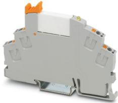
Modulo portarelè montato con connessione push-in, composto da: base relè con espulsore e relè a contatti dorati multistrato. Esecuzione contatti: 1 contatto in chiusura. Tensione di ingresso 24 V DC
