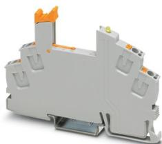
Base per relè RIF-0..., per relè di potenza in miniatura con 1 contatto in chiusura o relè a stato solido equivalenti dal punto di vista costruttivo, connessione Push-in, per il montaggio su NS 35/7,5
