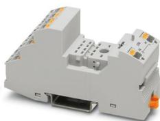
Base relè RIF-2..., per relè industriali con 2 o 4 contatti di scambio, connessione Push-in, possibilità d'innesto per modulo d'ingresso/antidisturbo, per il montaggio su NS 35/7,5
