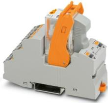
Modulo portarelè montato con connessione push-in, composto da: base relè, relè a contatto di potenza, modulo di segnalazione di stato e di soppressione dei disturbi a innesto e leva di fissaggio. Esecuzione contatti: 2 contatti di scambio. Tensione di ingresso: 230 V AC
