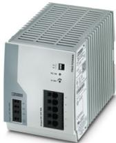
Alimentatore switching TRIO per montaggio su guida, ingresso: trifase, uscita: 24 V DC / 40 A, boost dinamico, tecnica di connessione rapida senza utensili per conduttori rigidi e flessibili con capocorda montato
