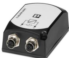
Isolatore di rete passivo per separazione galvanica nelle reti Ethernet. Per la protezione di dispositivi Ethernet da differenze di potenziale fino a 4 kV. Utilizzabile per velocità di trasmissione fino a 100 MBit/s. Connessione Ethernet mediante due connettori femmina M12 (codifica D).
