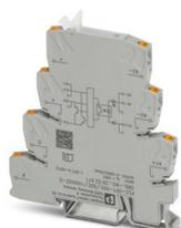
Relè a stato solido d'ingresso, con uscita in tensione continua controfase, frequenza di trasmissione 100 kHz, con LED e protezione nei circuiti di ingresso e uscita, ingresso: 5 V DC, uscita: 4 - 18 V DC/50 mA
