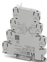
Relè a stato solido d'ingresso, con uscita in tensione continua controfase, frequenza di trasmissione 100 kHz, con LED e protezione nei circuiti di ingresso e uscita, ingresso: 24 V DC, uscita: 4 - 18 V DC/50 mA
