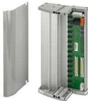
Termination Carrier universale per il collegamento ridondante di 16 moduli PSR-FSP alle schede di uscita digitali, mediante due connettori D-SUB, 37 poli (collegamento 1:1). Soluzione per applicazioni Emergency Shut Down (ESD)
