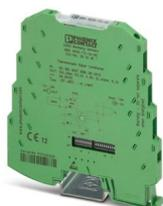
Convertitore per sensori di temperatura configurabile per il collegamento di termocoppie. Configurabile mediante DIP switch oppure con funzionalità ampliata mediante software. Connessione a vite, configurazione standard.
