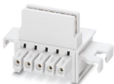
Connettore per guide di supporto, colore: grigio chiaro, corrente nominale: 8 A (contatti paralleli), tensione di dimensionamento (III/2): 125 V, numero poli: 5, serie di prodotti: TBUS5-17,5.., passo: 3,81 mm, montaggio: Montaggio su guida DIN, bloccaggio: assente, tipo di fissaggio: assente, tipo di confezione: confezionato nel cartone, Articolo con contatti dorati, connettore bus per il collegamento a custodie per l'elettronica, 5 contatti paralleli
