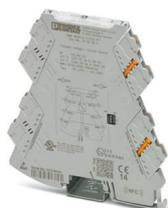
Fonte di tensione/corrente costante con tecnica di connessione a innesto, tensione d'ingresso 9,6 V DC ... 30 V DC. Tensione di uscita 1,25 V DC ... 10 V DC o corrente di uscita 2,5 mA ... 20 mA regolabile. Configurabile mediante DIP switch. Connessione push-in.
