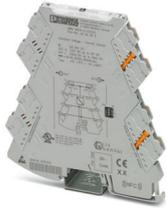
Fonte di tensione/corrente costante con tecnica di connessione a innesto, tensione d'ingresso: 9,6 V DC ... 30 V DC. Tensione di uscita: 1,25 V ... 10 V DC o corrente di uscita: 2,5 mA ... 20 mA regolabile. Configurabile mediante DIP switch. Connessione a vite.
