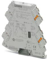
Separatore a 2 vie con loop di uscita alimentato con sistema di collegamento a innesto per la separazione galvanica di segnali analogici unipolari e bipolari. Ingresso configurabile mediante DIP switch. Connessione a vite, configurazione standard.
