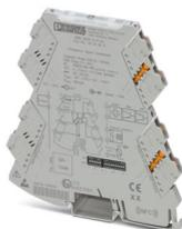
Convertitore di frequenza a configurazione universale per la conversione di segnali di frequenza (Hz/rpm) e segnali PWM in segnali normalizzati. Tensioni dei sensori superiori a 8,2 V DC, possibile combinazione con MINI MCR-2-SPS 1033202. Tecnologia di connessione a vite.
