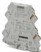
Convertitore di temperatura configurabile con sistema di collegamento a innesto per il collegamento di termoresistenze e potenziometri a 2, 3 e 4 conduttori. Configurazione tramite DIP switch o software. Connessione a vite, configurazione standard
