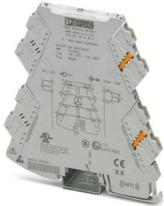
Isolatore galvanico a 3 vie con sistema di collegamento a innesto per la separazione galvanica di segnali analogici. Segnale d'ingresso: 0(4) mA ... 20 mA, segnale in uscita: 0(4) mA ... 20 mA, connessione push-in.
