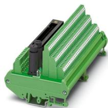
Modulo a 32 canali con connessione a vite a 3 conduttori e connettore ridondante. Adatto per schede Yokogawa ADV151, ADV161, ADV551, ADV561.
