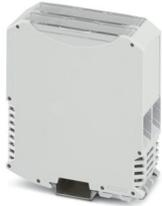
Custodie per guide DIN, Custodia completa con piedino di fissaggio in metallo, design alto, con feritoie di ventilazione, larghezza: 35,2 mm, altezza: 99 mm, profondità: 113,65 mm, colore: grigio chiaro (simili RAL 7035), collegamento trasversale: Connettore per guide di supporto (opzionale), n. poli connettore trasversale: 5
