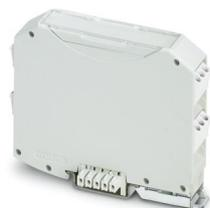
Custodie per guide DIN, Custodia completa con piedino di fissaggio in metallo, design super piatto, senza feritoia di ventilazione, larghezza: 17,6 mm, altezza: 85 mm, profondità: 69,55 mm, colore: grigio chiaro (simili RAL 7035), collegamento trasversale: Connettore per guide di supporto (opzionale), n. poli connettore trasversale: 5
