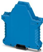
Custodie per guide DIN, Base custodia con piedino di fissaggio in metallo, con contatto FE, di tipo alto, con feritoie di ventilazione, larghezza: 22,6 mm, altezza: 99 mm, profondità: 107,3 mm, colore: blu (simili RAL 5015), collegamento trasversale: Connettore per guide di supporto (opzionale), n. poli connettore trasversale: 5
