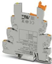
Morsetto base PLC da 6,2 mm per segnale TTL con connessione Push-in, senza equipagg. relè o relè a stato solido, per il montaggio su guida di montaggio, NS 35/7,5, 1 contatto aperto a riposo, tens. di ingr. TTL (5 V DC)
