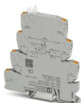
PLC-INTERFACE con contatto di feedback, composta da morsetto base PLC-O.../TTL con connessione Push-in e relè a stato solido in miniatura integrato, per il montaggio su guida di montaggio NS 35/7,5, 1 contatto aperto a riposo, ingresso: 24 V DC, uscita: 3-33 V DC/10 A
