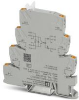
PLC-INTERFACE, relè a stato solido integrato, con connessione Push-in, per il montaggio su guida di supporto NS 35/7,5, ingresso: 60 V DC, uscita: 12-300 V DC/1 A
