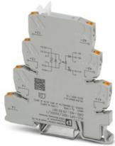
PLC-INTERFACE, relè a stato solido integrato, con connessione Push-in, per il montaggio su guida di supporto NS 35/7,5, ingresso: 5 V DC, uscita: 12-300 V DC/1 A
