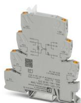
PLC-INTERFACE per applicazioni ferroviarie, composta da morsetto base con connessione Push-in e relè a stato solido in miniatura integrato, intervallo: da  $0,7 \times U_N$  a  $1,25 \times U_N$ , intervallo di temperatura:  $-25 \text{ °C}$  bis  $+70 \text{ °C}$ , , 1 contatto aperto a riposo, ingresso: 24 V DC, uscita: 3-33 V DC/3 A
