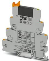
PLC-INTERFACE, per funzioni di output composta da morsetto base PLC-BPT.../ACT con connessione Push-in e relè a stato solido in miniatura a innesto, per il montaggio su guida di montaggio NS 35/7,5, 1 contatto aperto a riposo, ingresso: 24 V DC, uscita: 3-33 V DC/3 A
