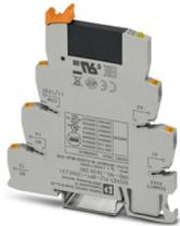
PLC-INTERFACE, composta da morsetto base PLC-BPT.../21 con connessione Push-in e relè a stato solido in miniatura a innesto, per il montaggio su guida di montaggio NS 35/7,5, 1 contatto aperto a riposo ingresso: 120 V AC/110 V DC, uscita: 24-253 V AC/ 0,75 A
