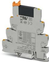
PLC-INTERFACE, composta da morsetto base PLC-BPT.../21 con connessione Push-in e relè a stato solido in miniatura a innesto, per il montaggio su guida di montaggio NS 35/7,5, 1 contatto aperto a riposo ingresso: 24 V DC, uscita: 24-253 V AC/ 0,75 A
