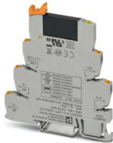
PLC-INTERFACE, composta da morsetto base PLC-BPT .../21 con connessione Push-in e relè a stato solido in miniatura a innesto, per il montaggio su guida di montaggio NS 35/7,5, 1 contatto aperto a riposo, ingresso: 24 V DC, uscita: 3-33 V DC/3 A
