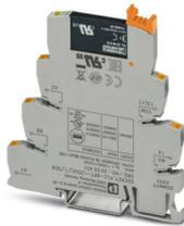
PLC-INTERFACE per funzioni di input, composta da morsetto base PLC-BPT.../SEN con connessione Push-in e relè a stato solido in miniatura a innesto, per il montaggio su guida di montaggio NS 35/7,5, 1 contatto aperto a riposo, ingresso: 120 V AC/110 V DC, uscita: 3-48 V DC/100 mA
