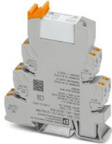
PLC-INTERFACE, per applicazioni ferroviarie composta da morsetto base con connessione Push-in e relè in miniatura a innesto con contatto in oro multistrato, intervallo: da  $0,7 \times U_N$  a  $1,25 \times U_N$ , classe di temperatura TX: da  $-40 \text{ °C}$  a  $+70 \text{ °C}$ , 2 contatti di scambio, tens. di ingresso 72 V DC
