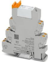
PLC-INTERFACE, per applicazioni ferroviarie composta da morsetto base con connessione Push-in e relè in miniatura a innesto con contatto in oro multistrato, intervallo: da 0,75 x UN a 1,15 x UN, frequenza nominale di ingresso 16,7 Hz, 2 contatti di scambio, tensione di ingresso 230 V AC
