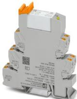
PLC-INTERFACE, composto da morsetto base PLC-BPT.../21-21 con connessione Push-in e relè in miniatura a innesto con contatto in oro multistrato, per il montaggio su guida di montaggio NS 35/7,5, 2 contatti di scambio, tens. di ingresso 60 V DC
