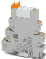
PLC-INTERFACE, composto da morsetto base PLC-BPT.../21-21 con connessione Push-in e relè in miniatura a innesto con contatto in oro multistrato, per il montaggio su guida di montaggio NS 35/7,5, 2 contatti di scambio, tens. di ingresso 12 V DC
