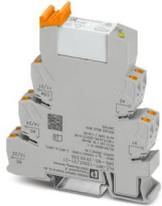
PLC-INTERFACE, composto da morsetto base PLC-BPT.../21-21 con connessione Push-in e relè in miniatura a innesto con contatto di potenza, per il montaggio su guida di supporto NS 35/7,5, 2 contatti di scambio, tens. di ingresso 120 V AC/DC
