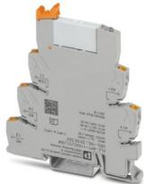
PLC-INTERFACE, per applicazioni ferroviarie composta da morsetto base con connessione Push-in e relè in miniatura a innesto con contatto di potenza, intervallo: da  $0,7 \times U_N$  a  $1,25 \times U_N$ , classe di temperatura TX: da  $-40 \text{ °C}$  a  $+70 \text{ °C}$ , 1 contatti di scambio, tens. di ingresso 110 V DC
